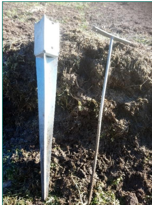
Abbildung 2: Unterschiedliche Formen von Erdstäben. Der eckige Erdstab (links) hat eine größere Oberfläche als der Runde. Foto: Frank Lamprecht.
